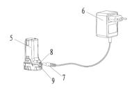
Inserire la spina nel trasformatore 6 in una presa di corrente e l'adattatore spina 7 nella batteria 5 sulla stazione di ricarica 8. A questo punto, l'indicatore di controllo della carica della batteria 9 si accende. L'indicatore si accende in
